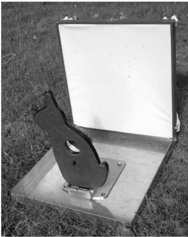
Abbildung 6.4.6.2 Seitenansicht eines Field-Target-Geschossfanges
